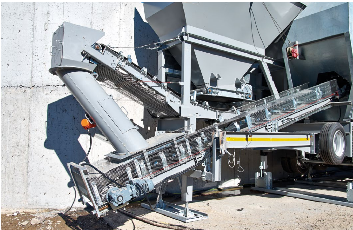
Компактно и эффективно: транспортировка инертных материалов от предварительного дозирования к сушильному барабану.
