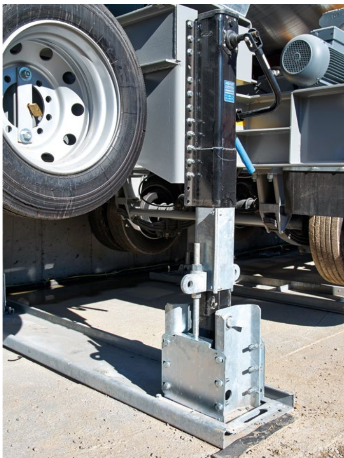
Для монтажа не требуется специальных фундаментов. Рабочая площадка должна быть лишь ровной и уплотненной.
