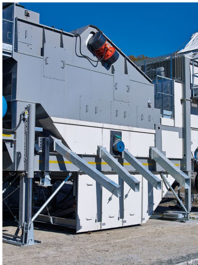
Полуприцеп содержит грохот, бункер горячих минералов и перепускные каналы, а также скиповый подъемник к смесителю с интегрированной системой взвешивания минеральных материалов.
