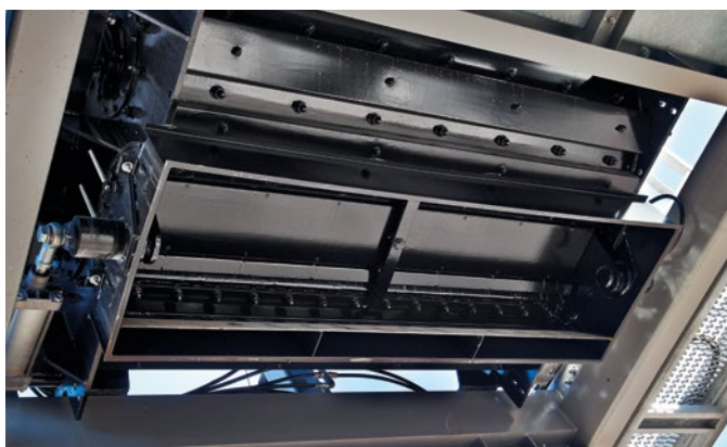
Прямая разгрузка: смеситель оснащен широкими разгрузочными заслонками.
